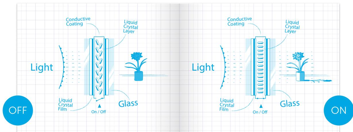
随机排列的液晶分子使得光线散射使玻璃不透明，适合于投影，保护隐私和绘图。
