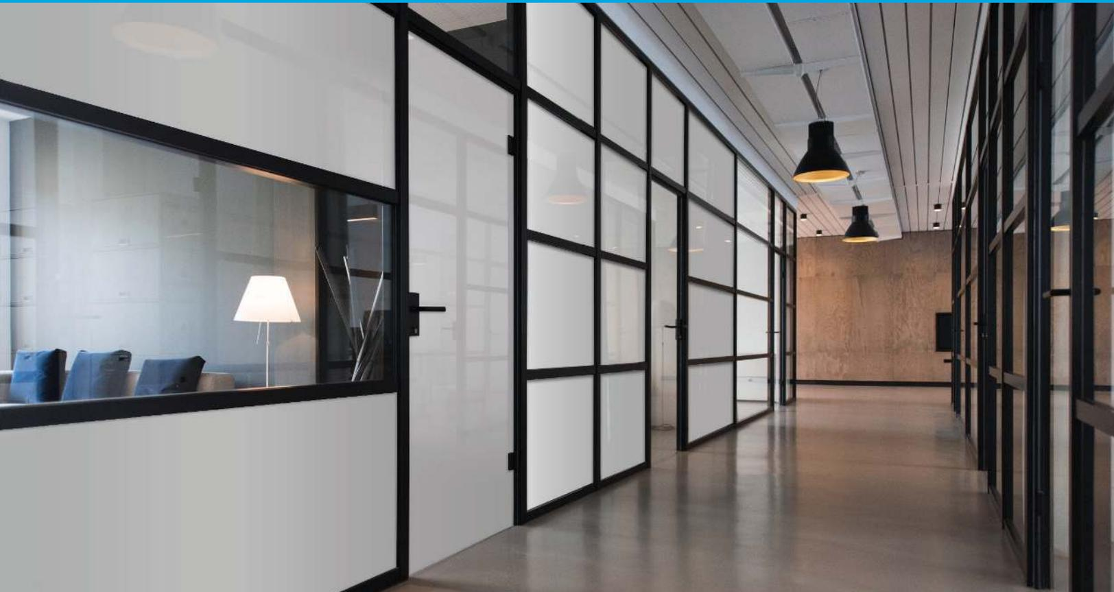
调光玻璃（LCG<sup>®</sup>）窗户和隔断遵循极简主义设计理念的同时灵活适用于多种应用场景：雾化状态下可用于隐私保护和投影成像，通透状态下视野开阔且隔而不断。
